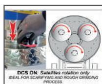
Con sistema DCS inserito per rapida rimozione di resine e colle, preparazione di pavimentazioni industriali, lucidatura a specchio CLS esposizione degli aggregati e rapida livellatura di qualsiasi superficie.
