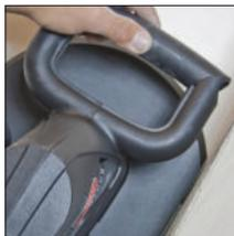
La cappa di aspirazione con segmento laterale staccabile per effettuare lavori a filo muro.
