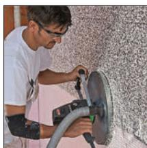
L'elevato diametro dell'utensile, permette una veloce e uniforme asportazione del materiale da lavorare.
