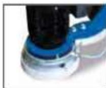
Cappa apribile e testa basculante per lavorare a filo muro.
