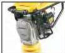
Protezione inferiore del motore avvolgente.
