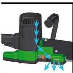
Il sistema di ventilazione forzata aiuta l'espulsione dei detriti
