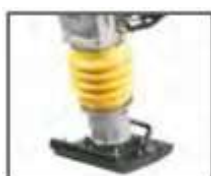
Struttura rinforzata del "piede".
